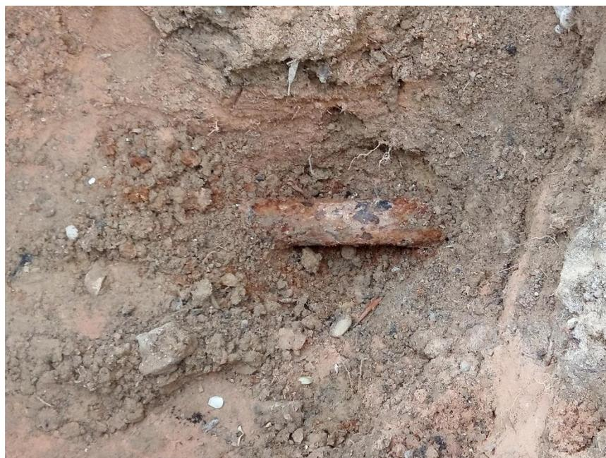
*Fig III. 22: Conduite corrodé en acier galvanisé 2018*
