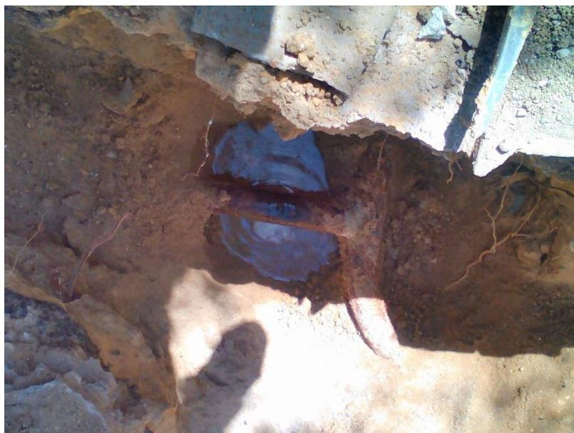
*Fig III. 23: Fuite dans un branchement en acier galvanisé 2018*
