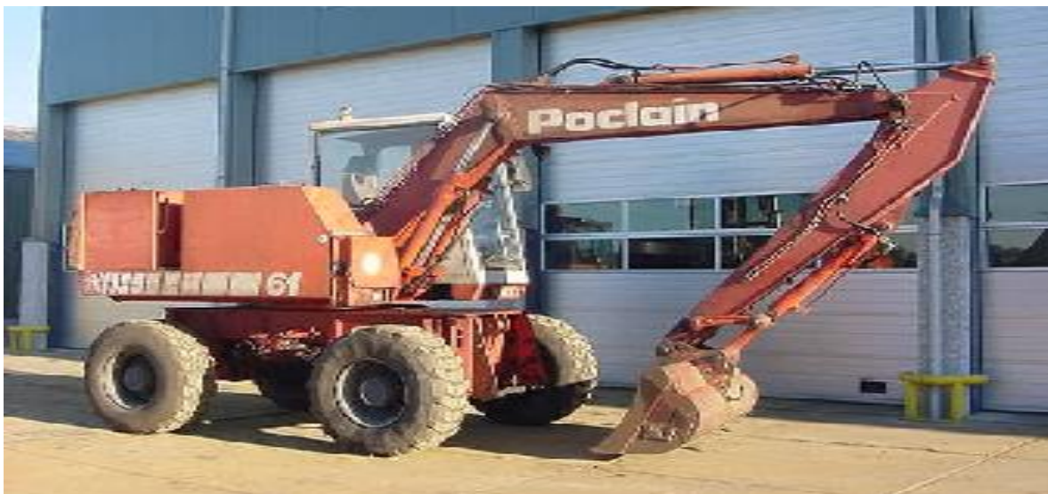
Figure VI. N°6 : Pelle équipée en rétro
