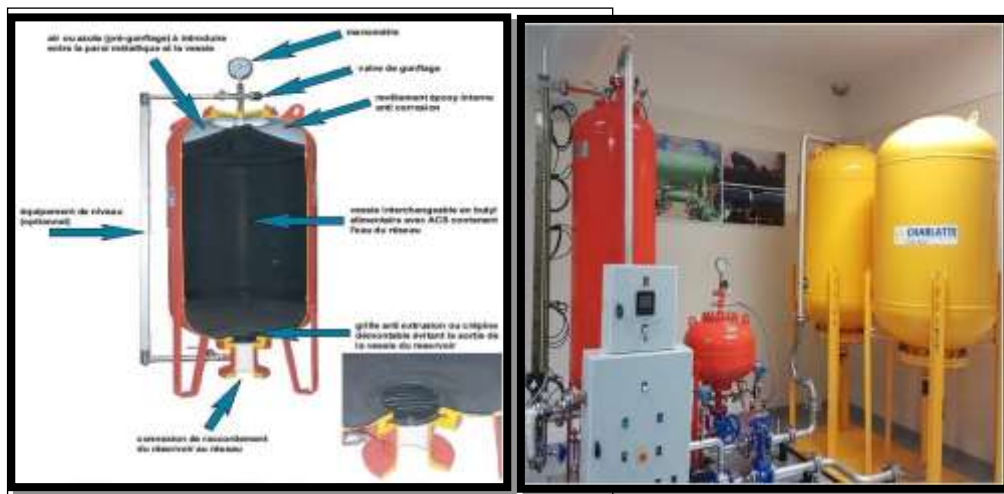
Figure VIII.8: Réservoir anti bélier à vessie butyle (d'après document CHARLATTE)
