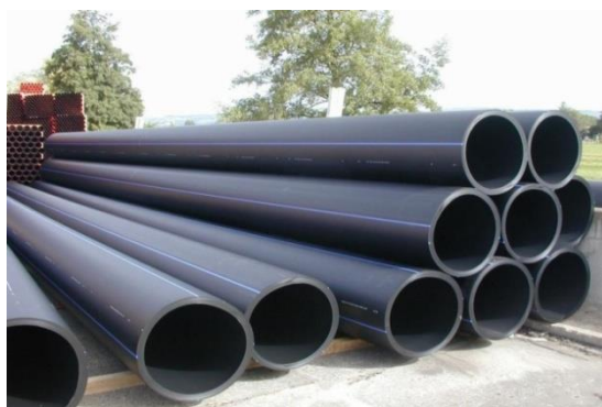
Figure N° IV.1 Conduite en PEHD
