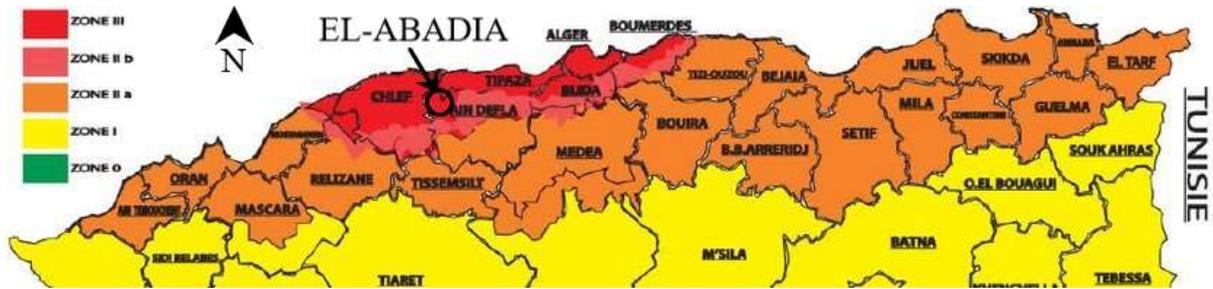
Figure I-3: Carte de zonage sismique du nord d'Algérie
