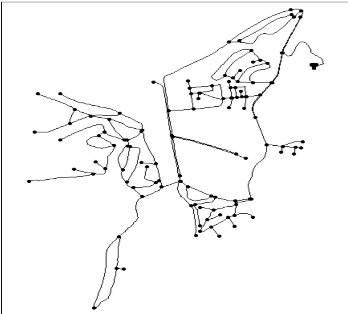
**Figure II.7:**Tracé de la simulation du réseau de distribution existant du secteur caserne ouest
