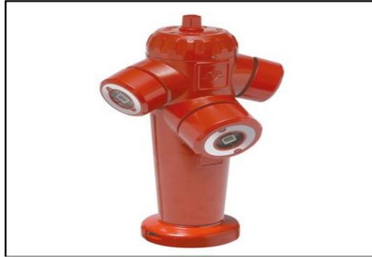
**Figure VI.11:**Poteau d'incendie avec prise centrale de DN 100 mm et deux prises latérales en DN 65mm.
