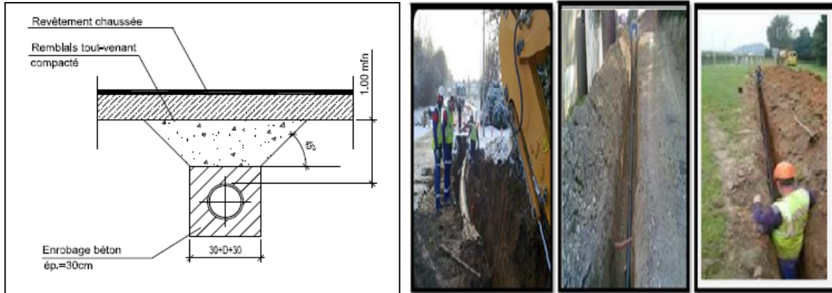
Figure VI.1 : Pose de canalisation dans un terrain ordinaire
