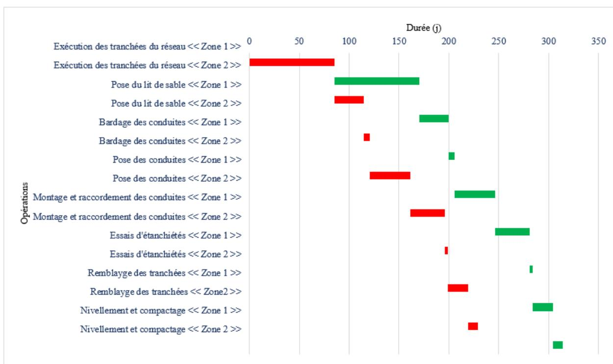
FIGURE 9.2 – Diagramme de GANTT pour la distribution
