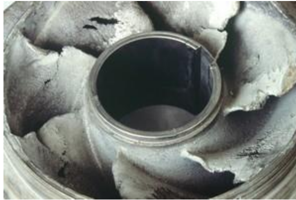
Figure V.6 : Roue soumise à la cavitation.
