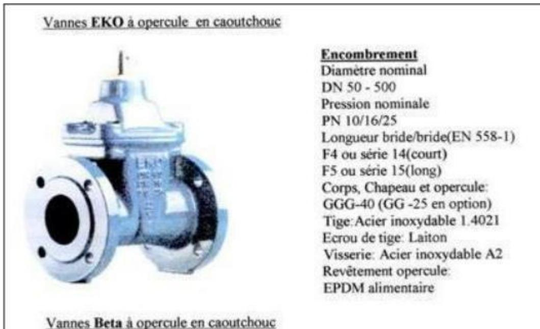
Figure VI-4: Robinet vanne à opercule (d'après W.A.E)
