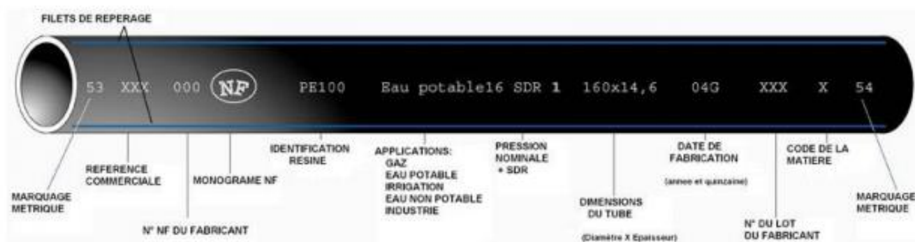
Figure VI.1 : Marquage du tube en PEHD
