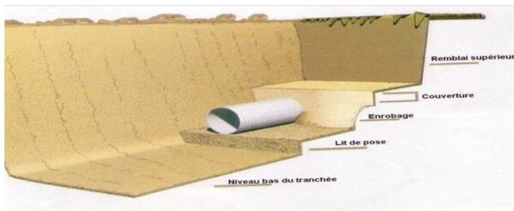
Figure N°VII.4: Remblayage de la tranchée [DIPRA]
