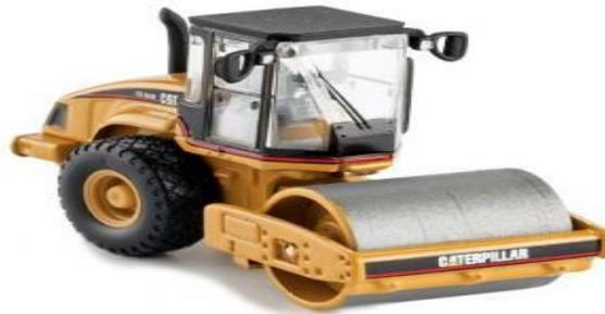
Figure N°VII.6: Compacteur à rouleau lisse
