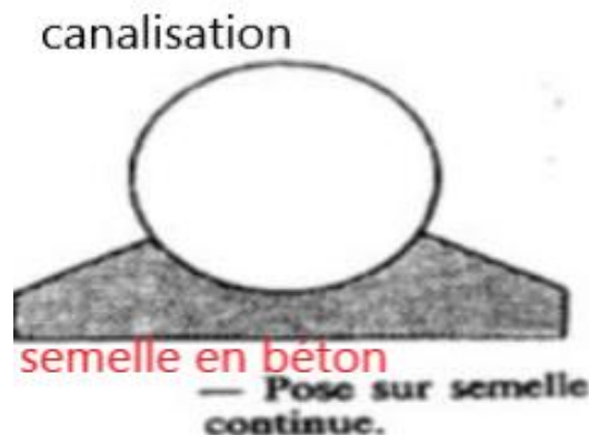
Figure (V-1) : Pose de conduite en tranchée dans un terrain peu consistant (Alimentation en eau potable des agglomérations, Mr B.SALAH ,2014).
