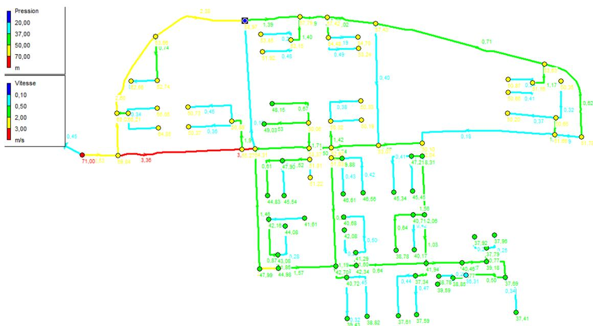
Figure IV.3: Simulation sur EPANET pour le cas pointe + incendie
