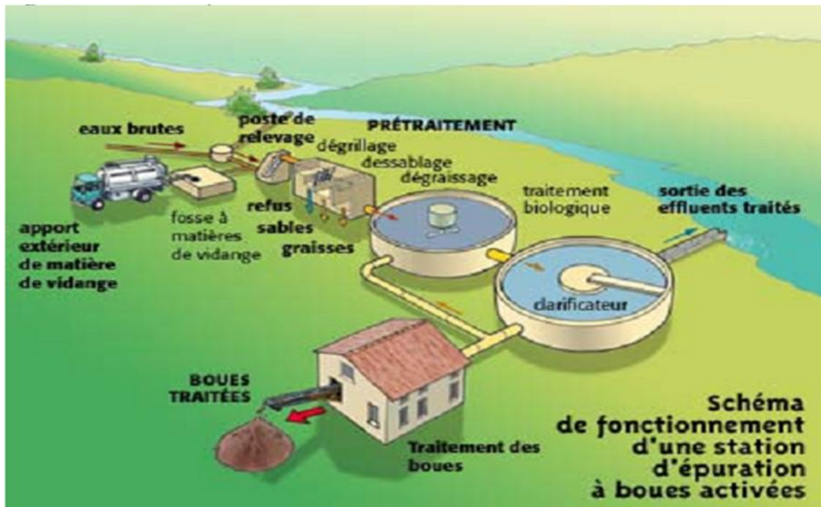
Figure I.1: Station d'épuration à boues activées (AMORCE, 2012)
