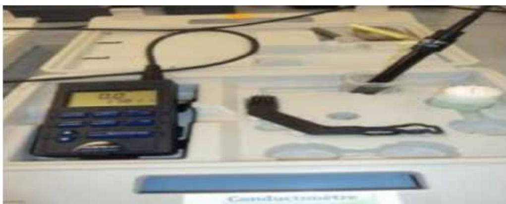
**Figure III.6:** Conductimètre
