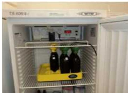
**Figure III.8:** DBO mètre.
