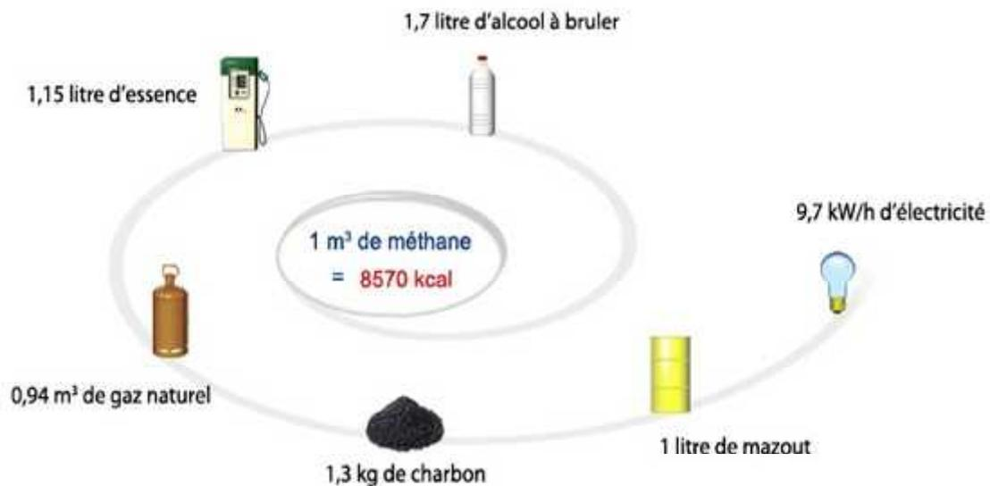
**Figure V.12:** Equivalence énergétique de méthane.
