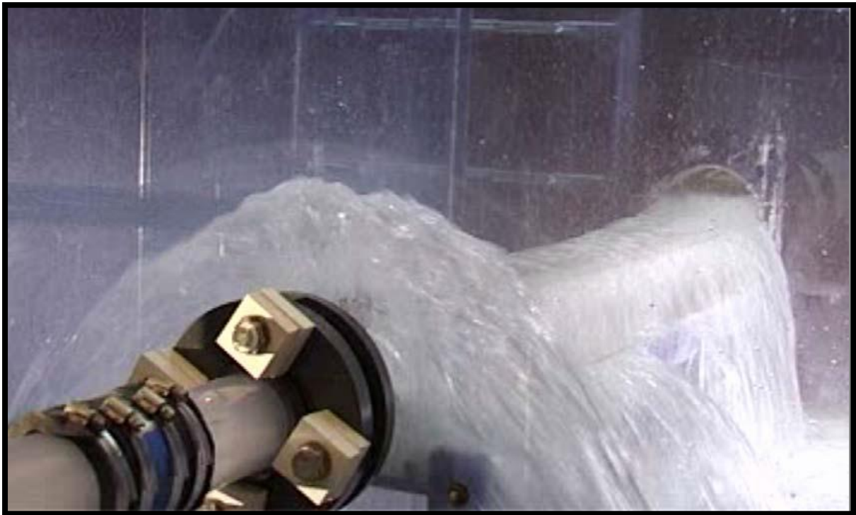
Figure 4.2: Fonctionnement d'un déversoir latéral à seuil haut
