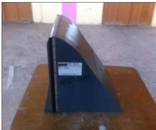
**Figure.II.20.**déversoir à arrête arrondie avec évacuateur à pente raide.
