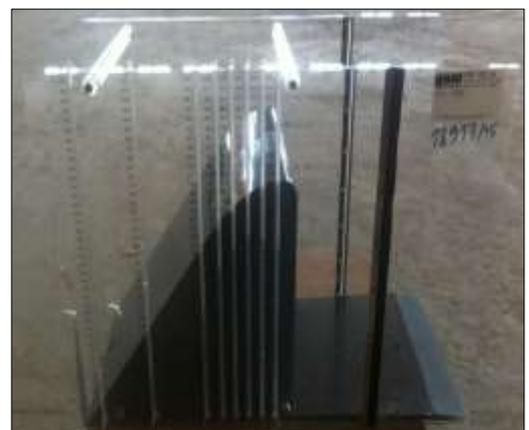
**figure.II.25.** déversoir à tête arrondie avec mesure de pression.
