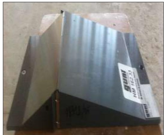
figure.II.27. déversoir cunéiforme.
