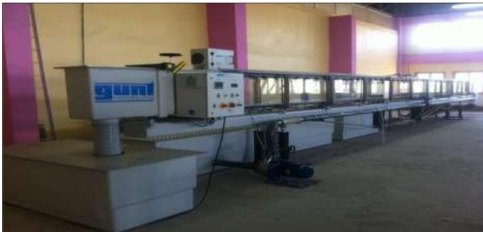
figure.II.2.le canal expérimental.
