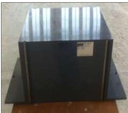
**figure.II.17.déversoir à paroi épaisse avec arrêtes vives**
