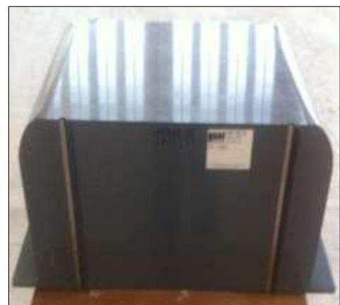
**figure.II.18.déversoir à paroi épaisse avec arrêtes arrondies.**
