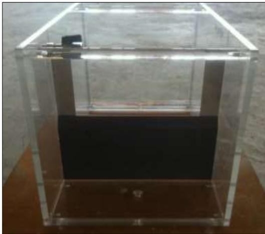
**figure.II.12.**déversoir rectangulaire avec contraction latérale.
