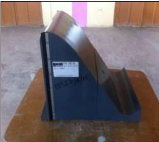
**Figure.II.22.** déversoir à arrête arrondie avec évacuateur en saut de ski.
