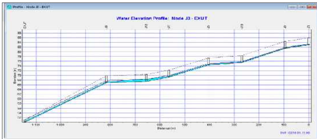
Figure IV.12 : le niveau d'eau dans les collecteurs J3-EXUT
