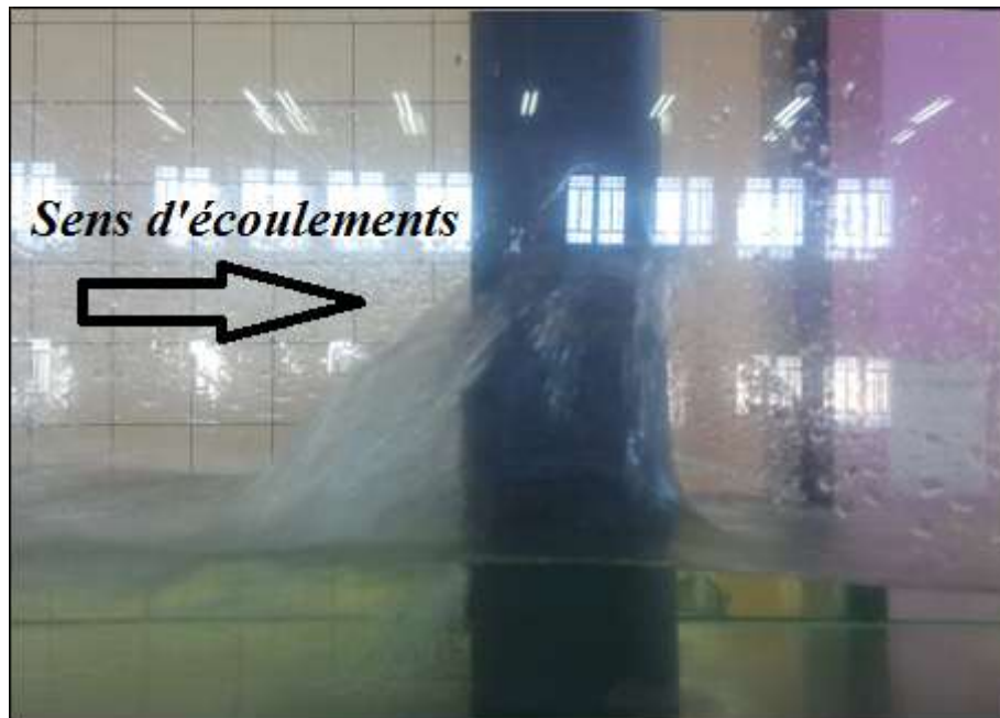
Figure III.3: Jet au niveau de la pile
