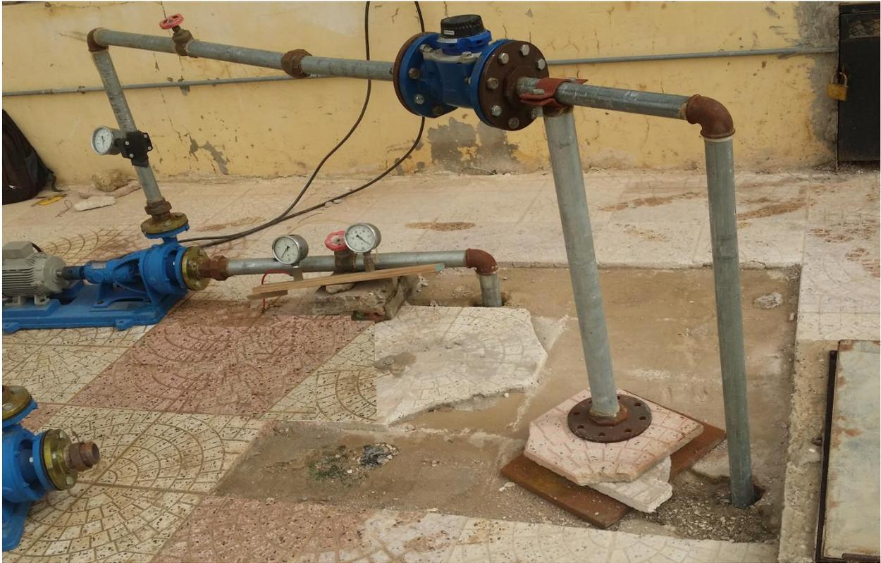
**Figure III.2 :** Installation du banc d'essai avec une seule pompe.
