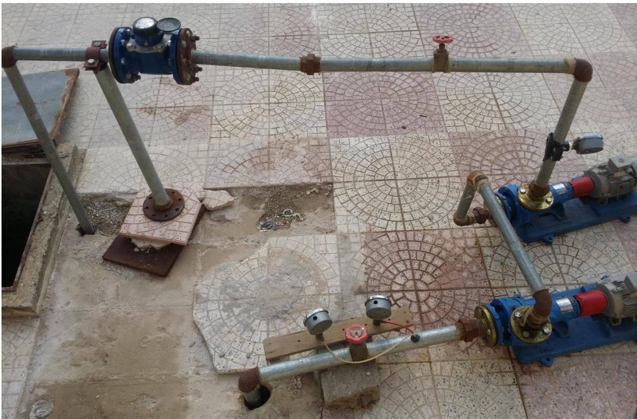
**Figure III.3 :** Installation du banc d'essai avec les deux pompes identiques montées en série.
