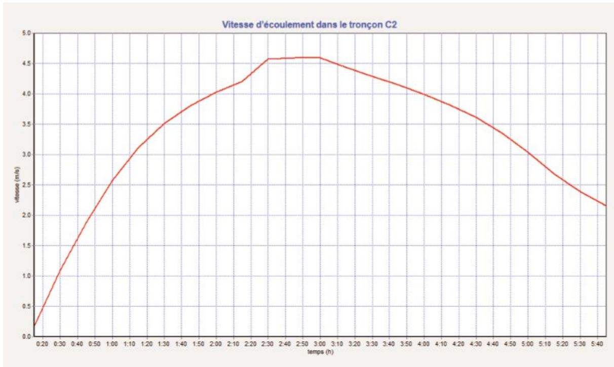
Figure III.13 : Vitesse d'écoulement dans le tronçon C2.
