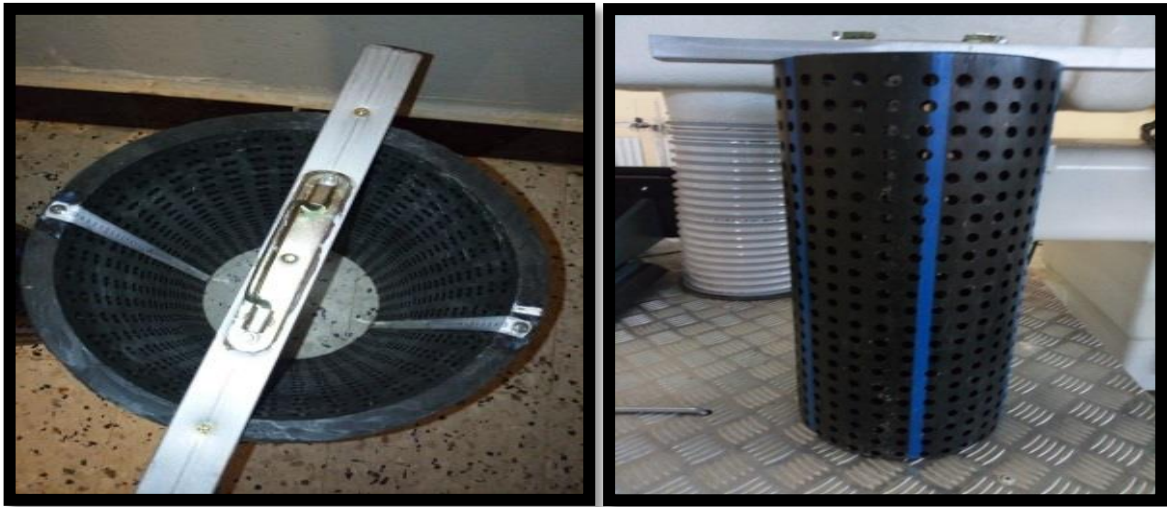
Figure IV.24 : L'état final de déversoir cylindrique.
