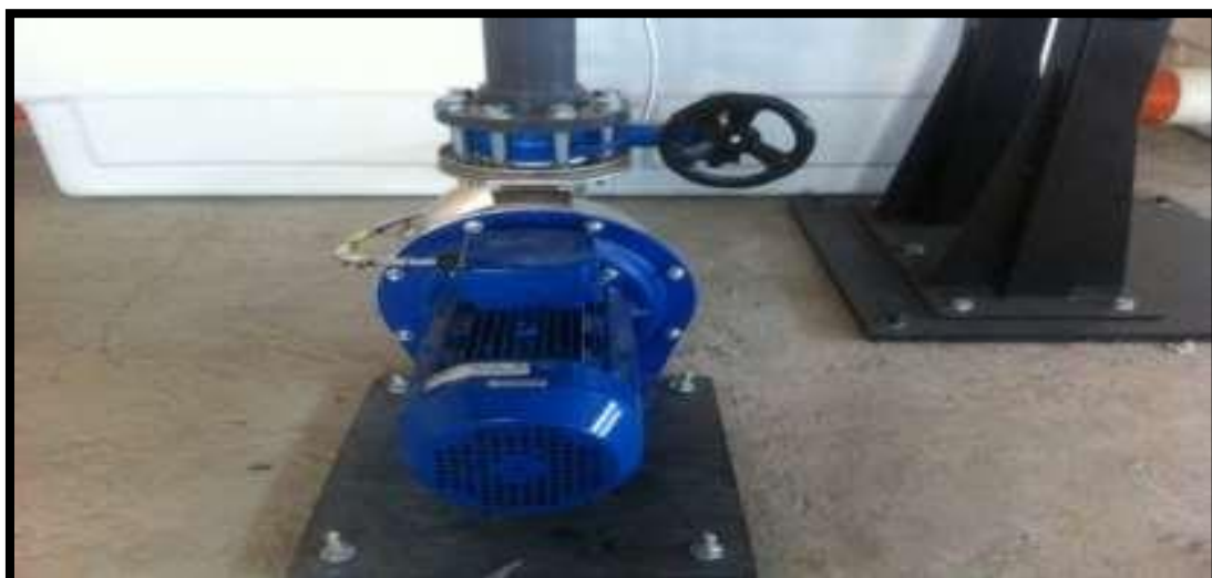
Figure.IV.4 : Elément de Pompage du dispositif expérimentale.
