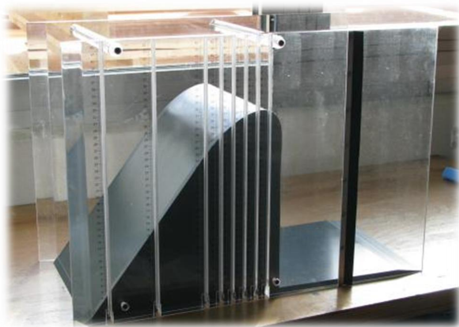
Figure III.13 : Déversoir à crête arrondie
