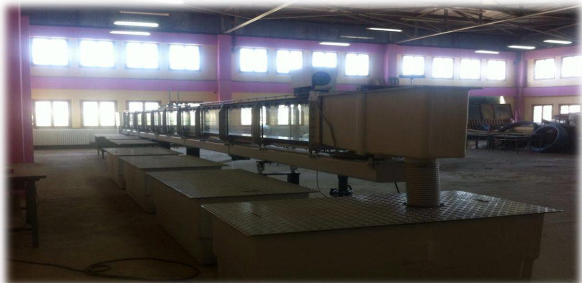
Figure III.3 : Réservoirs du canal de type Hm160
