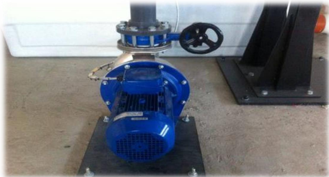
Figure III.4 : Pompe d'essai du dispositif
