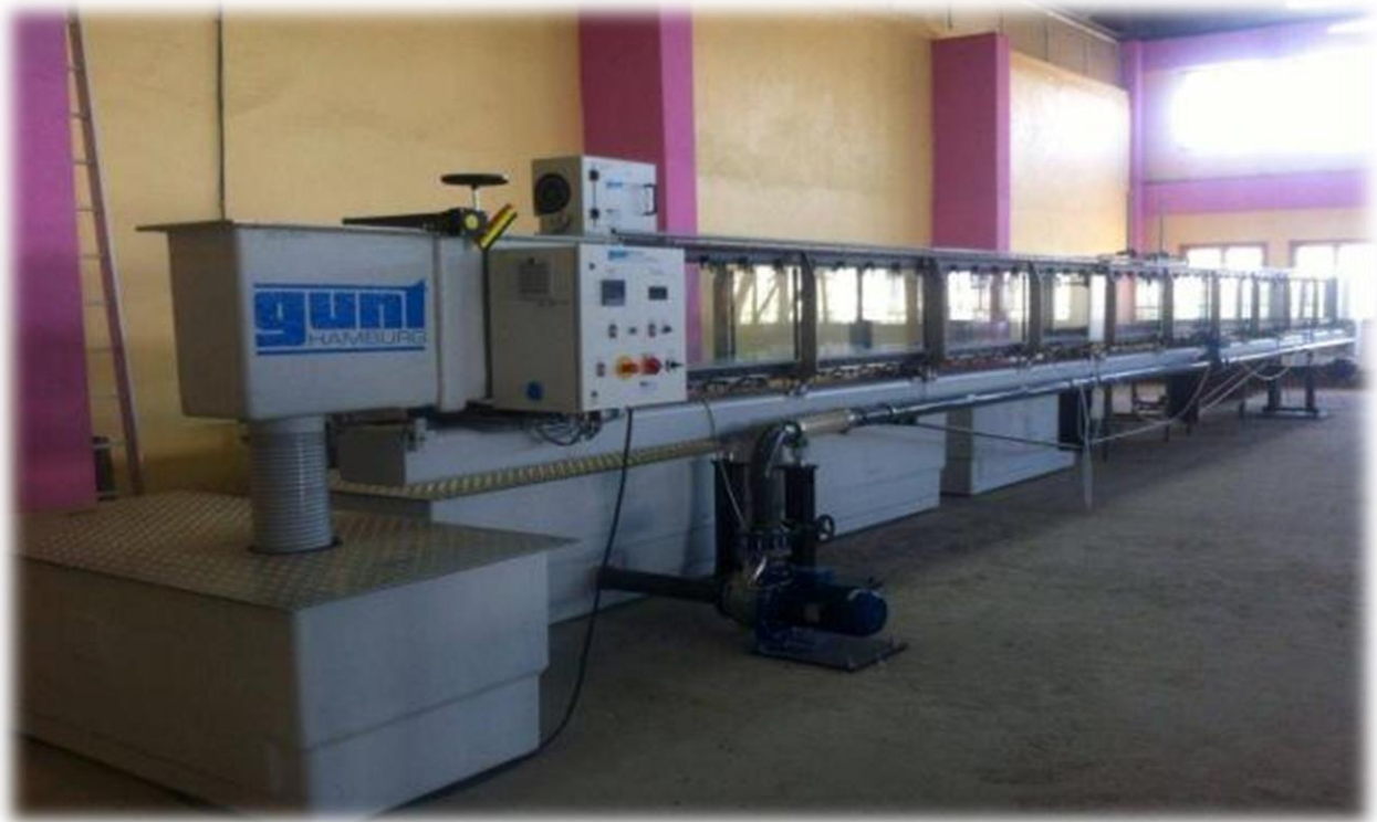
Figure III.1 : Photo du canal d'essai
