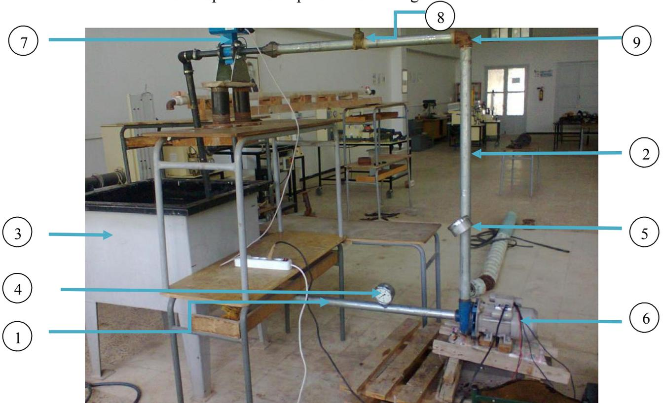
**FigureIII-1** : Banc d'essai d'expérimentation de la pompe.
