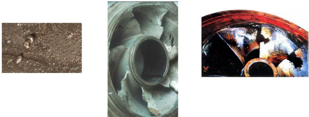
Figure I.11: Érosion par cavitation d'une roue de pompe
