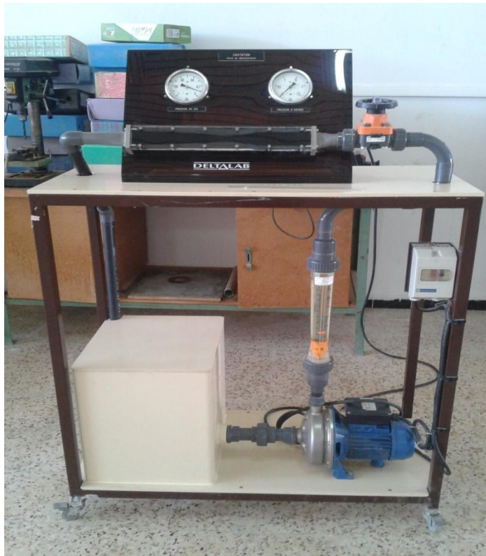
Figure III.1-Appareil de démonstration de la cavitation EH505
