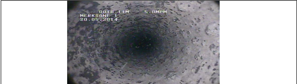
Figure IV.07 : Auscultation du forage de MERKSANE à la partie profondeur 8.17m a 18.37m.
