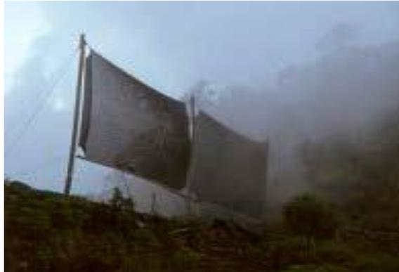
**Figure 2-1 : Un filet à brouillard installé dans le village Danda Bazzar (Népal)**
