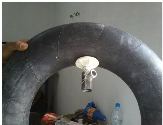
**Figure IV.11 :** montage de la valve des chambres à air.
