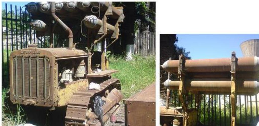
**Figure III.2 :** Tracteur fonctionnant au biogaz
