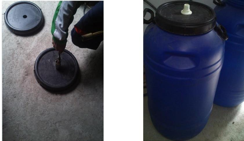
**Figure IV.7:** les étapes de perçage des couvercles des digesteurs
