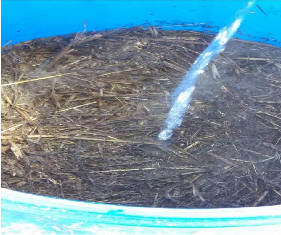
**FiguresIV.10:** ajout de l'eau chaude à une température de 60-70°C
