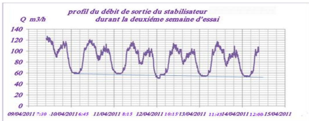
Figure III.7: Profil du débit de sortie du stabilisateur Oued Merzoug durant la deuxième semaine d'essai.
