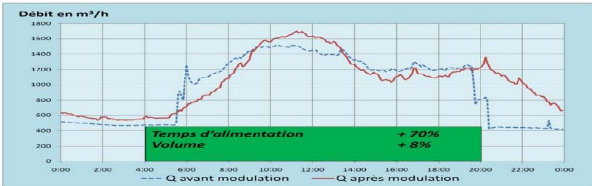
Figure II.6: Débit mis en distribution avant et après modulation de pression dans l'étage T3. [Document technique. SEAAL.2015].
