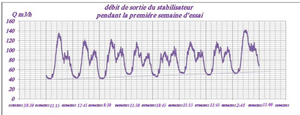
Figure III.6: Débit de sortie du stabilisateur Oued Merzoug durant la première semaine d’essai.
