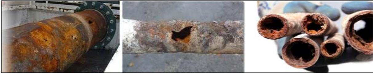
**Figure II.3** : Conséquences des eaux agressives sur les réseaux de distribution. [10]
