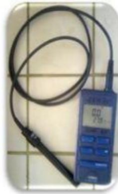
**Figure III-3** : conductimètre(ACHICHE Krime, LARBI Samir 2010)
