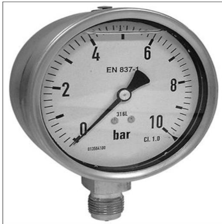
Figure VI.17. Manomètre (d'après document BAMO)
