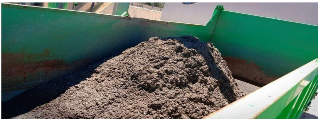
Figure II.3 : Image des déchets dans le dégrillage fin
