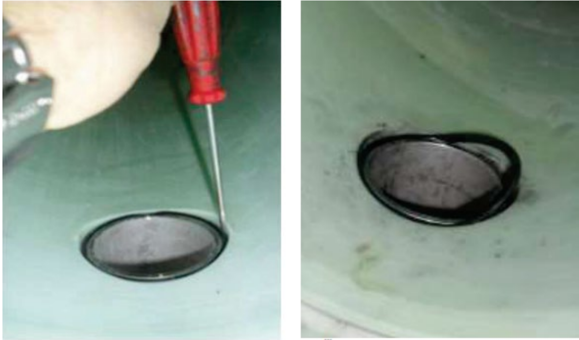
Figure 24: Changement du joint torique du tube à pression
