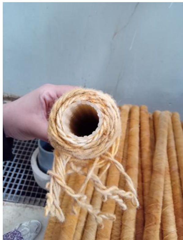
Figure III.7 : Coupe d'un filtre à cartouches
