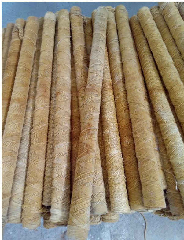
Figure III.6 : Filtres à cartouches 5 microns
