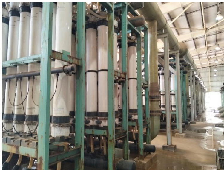
Figure III. 5 : le système d'ultrafiltration
