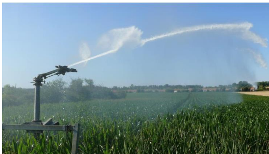
Figure V-3: Un canon d'arrosage.
