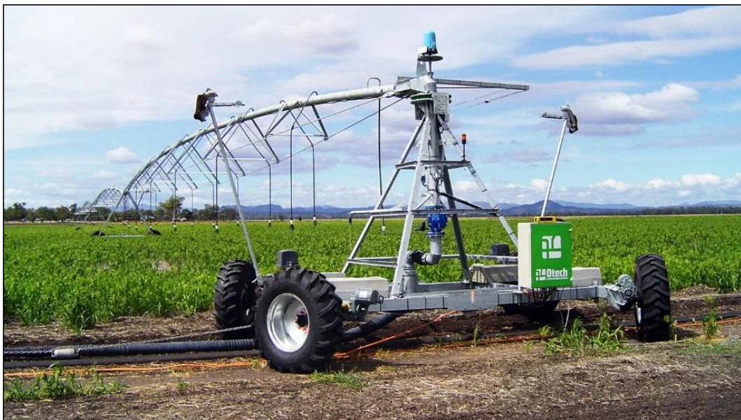
Figure V.5 : Irrigation par rampe frontale
