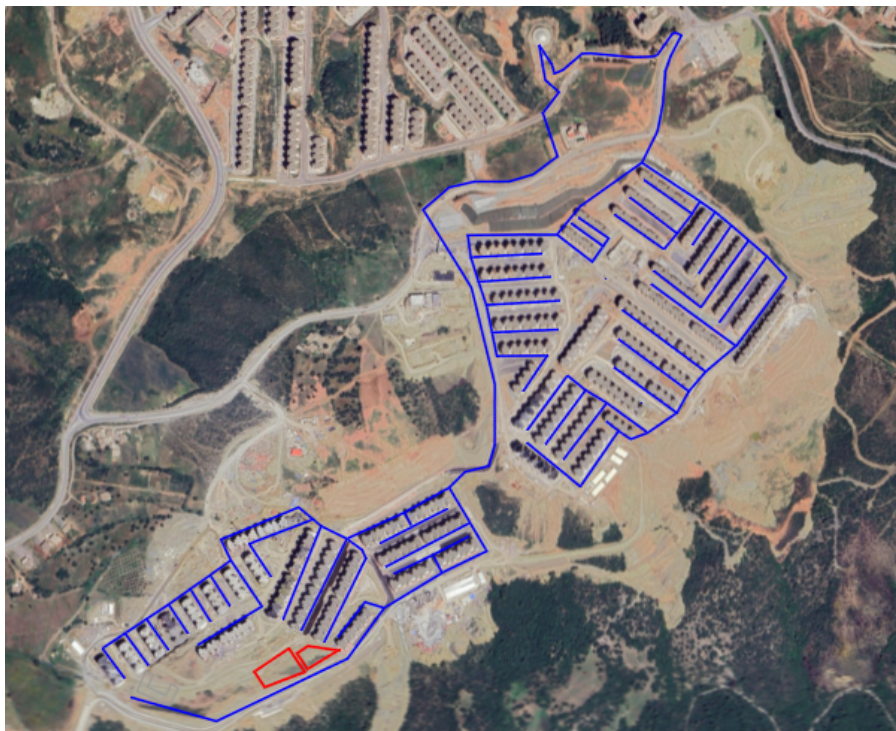
Fig. VI.19 – Tracé du réseau de distribution variante 3.
