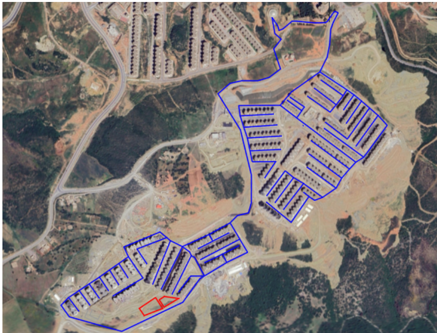
Fig. VI.8 – Tracé du réseau de distribution variante 2.
