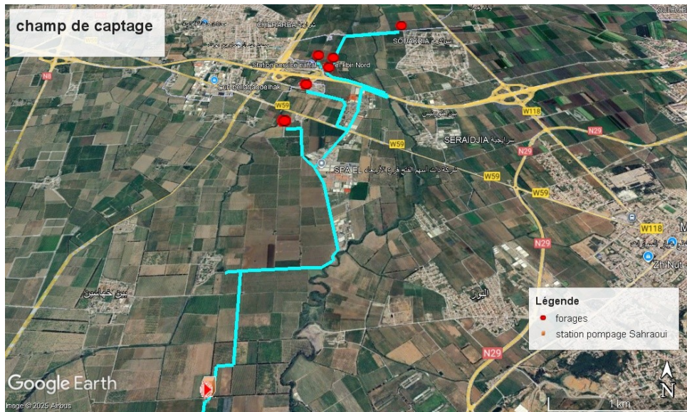
Fig. III.1 – Image satellitaire du champ de captage (forages vers station pompage sahraoui). (Googel Earth, 2025)
