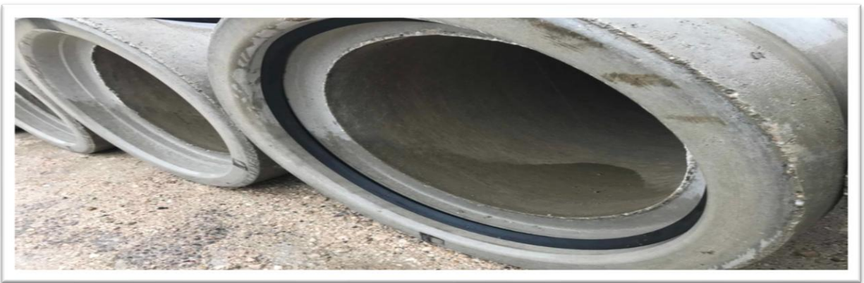
Figure (VI-5) : Joint torique.
