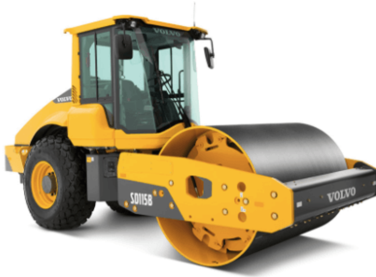
FIG. 7.5 : Le rouleau compresseur
