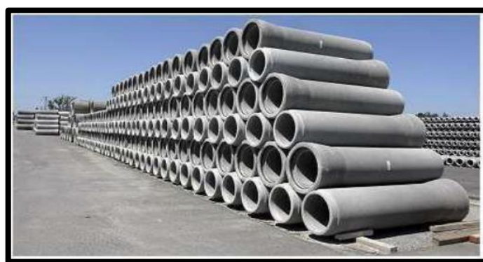
Figure VI-32 : Stockage de collecteurs
