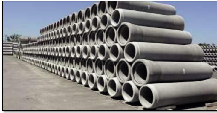
Figure V-26 : Des conduites en béton
