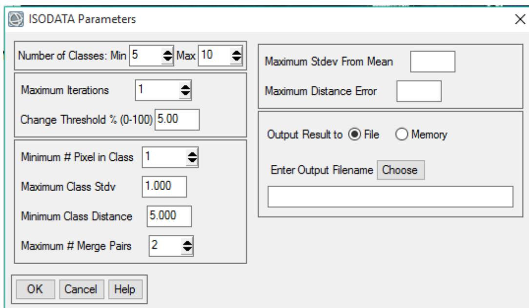
**Figure IV.4** Configuration de l'algorithme ISODATA sur ENVI
