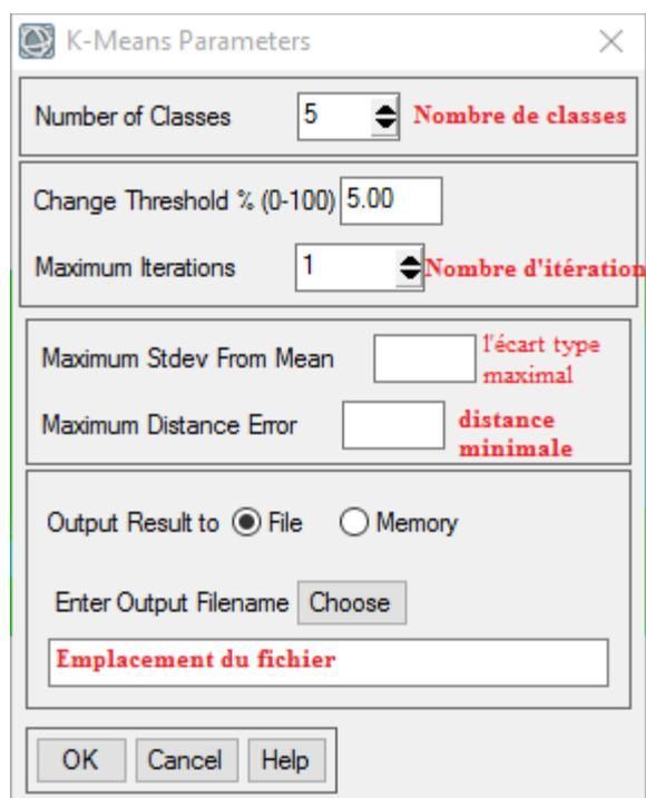
**Figure IV.2** Configuration de l'algorithme K-means sur ENVI
