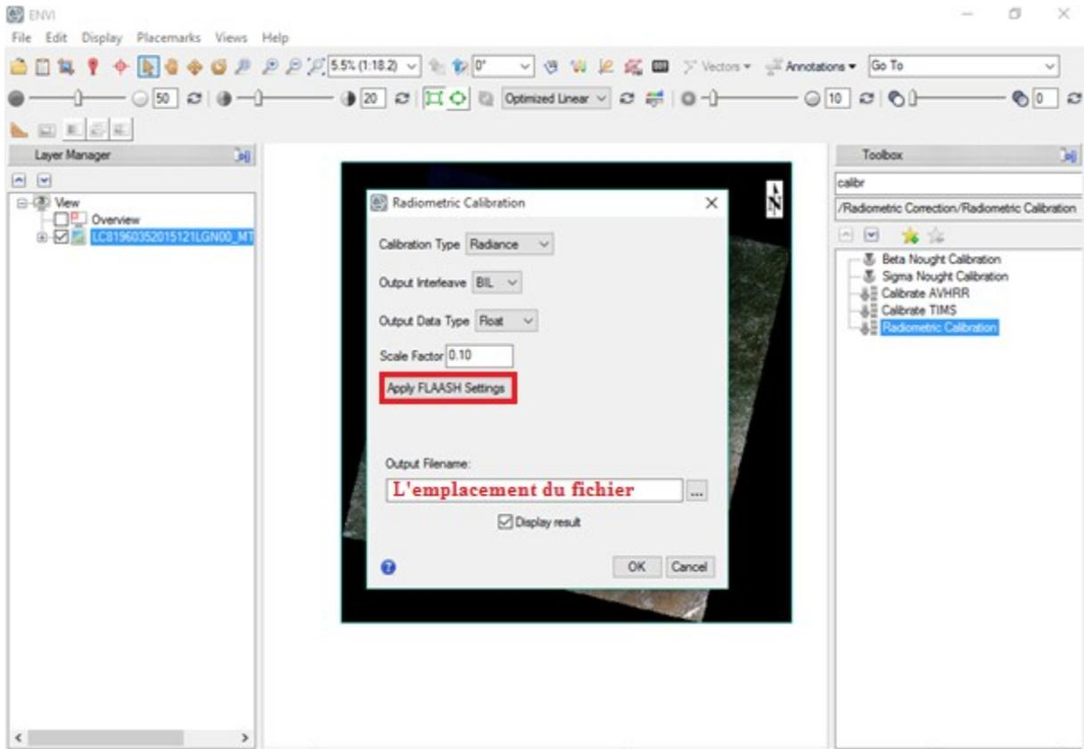
Figure III.4 : Etape de correction radiométrique sur ENVI
