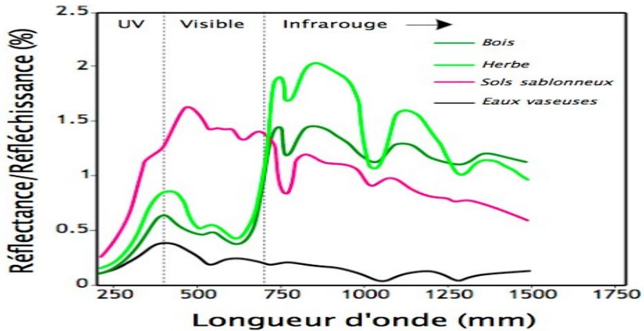
Figure I.4 : La signature spectrale de quatre surfaces.
