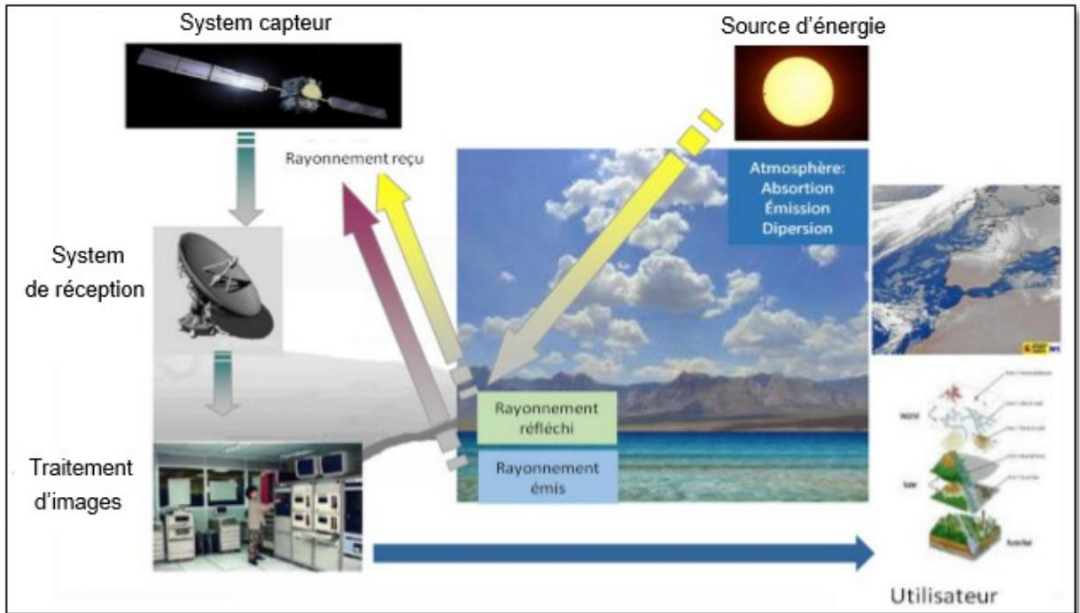
**Figure I.1** : Schéma général de fonctionnement (source Manuel TELCAN, 2013)
