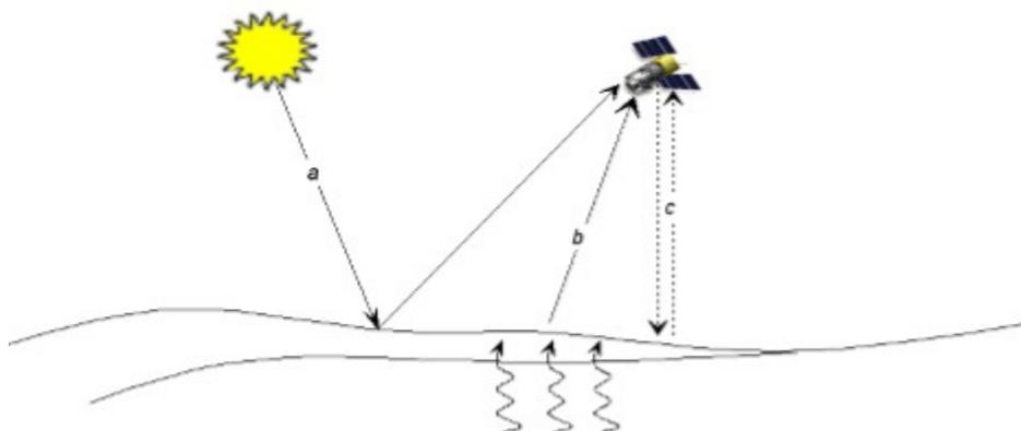
**Figure I.8 :** Classification des capteurs selon la forme de télédétection (source Manuel TELCAN, 2013)
