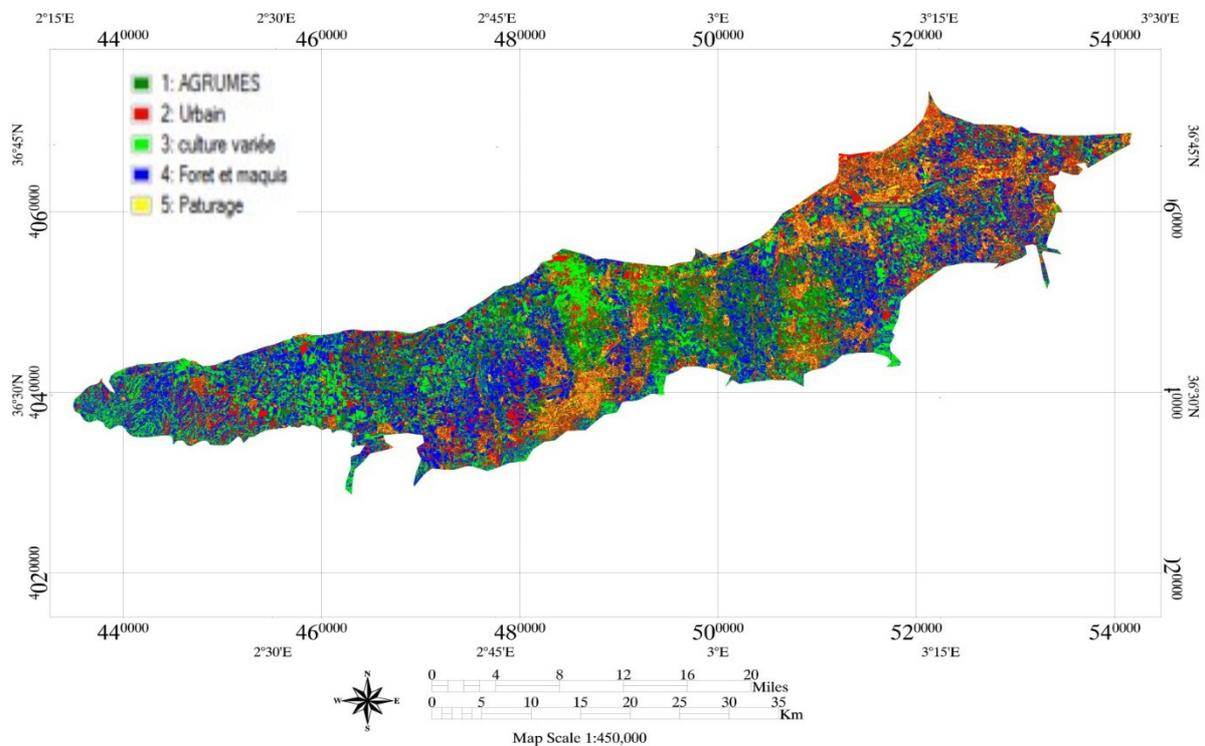
**Figure IV.9 :** Classification supervisée de la plaine de la Mitidja avec l’algorithme maximum de vraisemblance (image du 01-05-2016)
