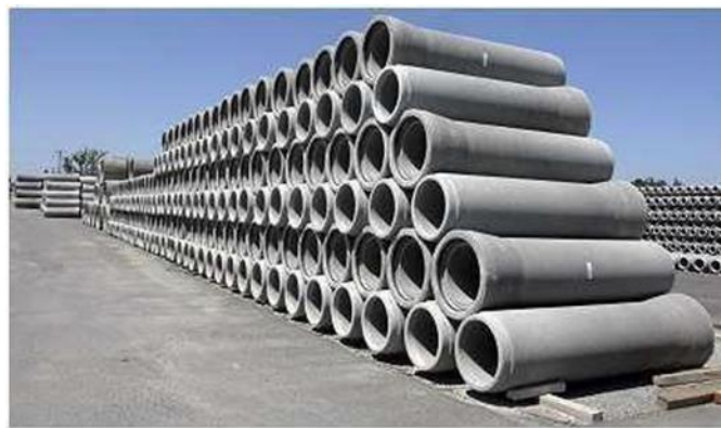
Figure VIII.1: Stockage de collecteurs
