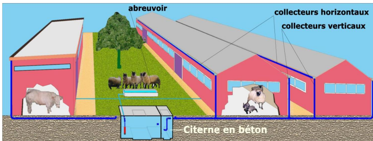
Figure III-6 : Système de récupération d'eau de pluie /Bâtiment à usage agricole
