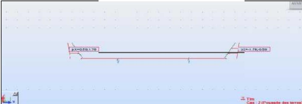
**Figure. VI.2. Les poussées des terres agissant sur le canal**
