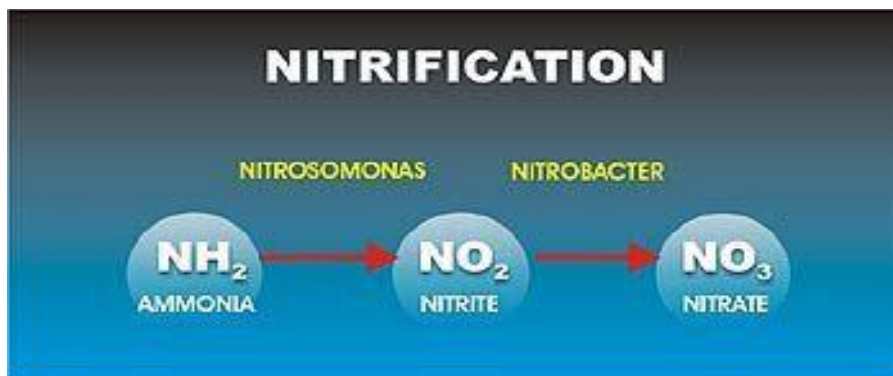
Figure II-2 schéma explicatif du processus de nitrification
