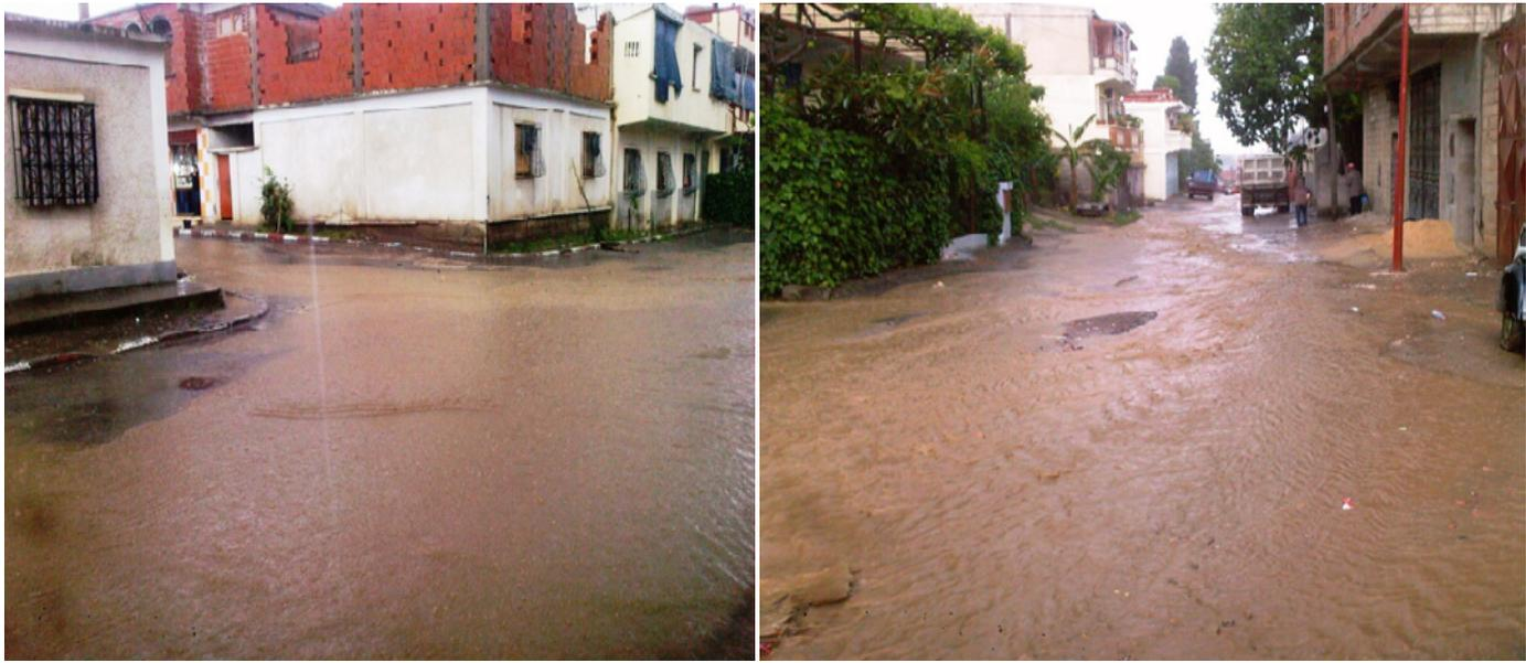
Figure II-1 : Rues inondées à cause de l'absence et l'obturation des bouches
