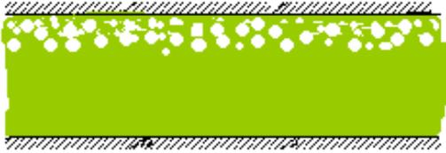
**Fig 1.5** Ecoulement à bulles
